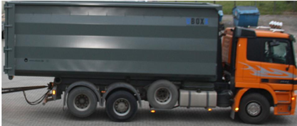
Wie beim PKW: auf den  $c_w$ -Wert kommt es an. Der Wegfall der seitlichen Spanten zur Versteifung kann laut Untersuchungen eine Kraftstoffeinsparung von 7 % – 10 % bedeuten.
