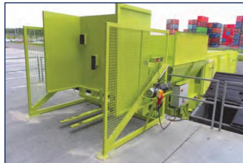
• stationäre Hub- Kippvorrichtung mit Zinkenaufnahme für Sonderbehälter
