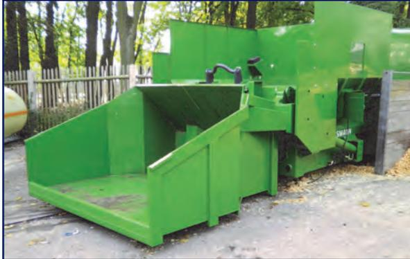
• SPB 20 SEL-E mit angebauter Hub- Kippvorrichtung als Ladeschaufel 3,5 cbm
