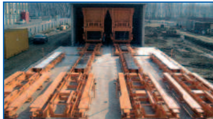
2 x MP6000 im Parallelbetrieb mit Rollenbahn als Containerwechseleinrichtung
