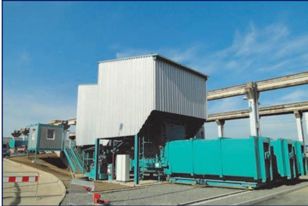
• Umladestation mit Querverschiebeanlagen für 3 Presscontainer
