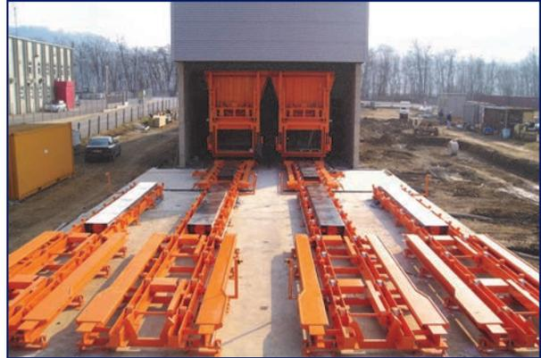
• Quer- und Längsverschiebeeinrichtung mit Rollenbahn
