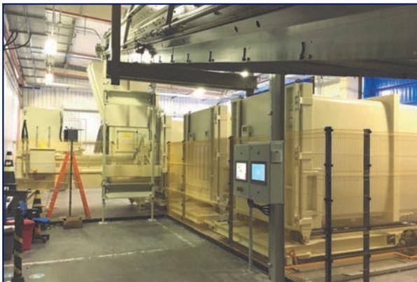
• Druckereipresse mit automatischer Wechselstation für 3 Presscontainer
