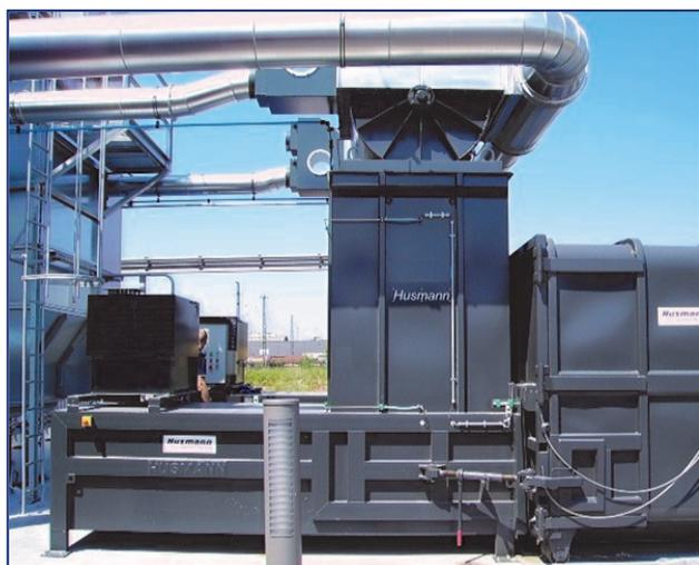
• MP 1300 mit Trichter unter Zellradschleuse
