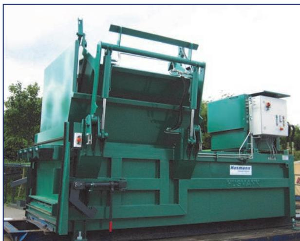
• MP 1300 mit angebauter Hub- Kippvorrichtung
